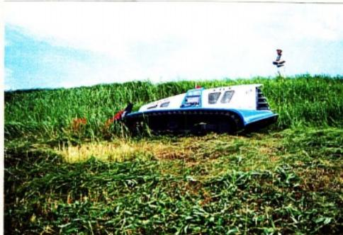
大型遠隔操縦除草機械による
